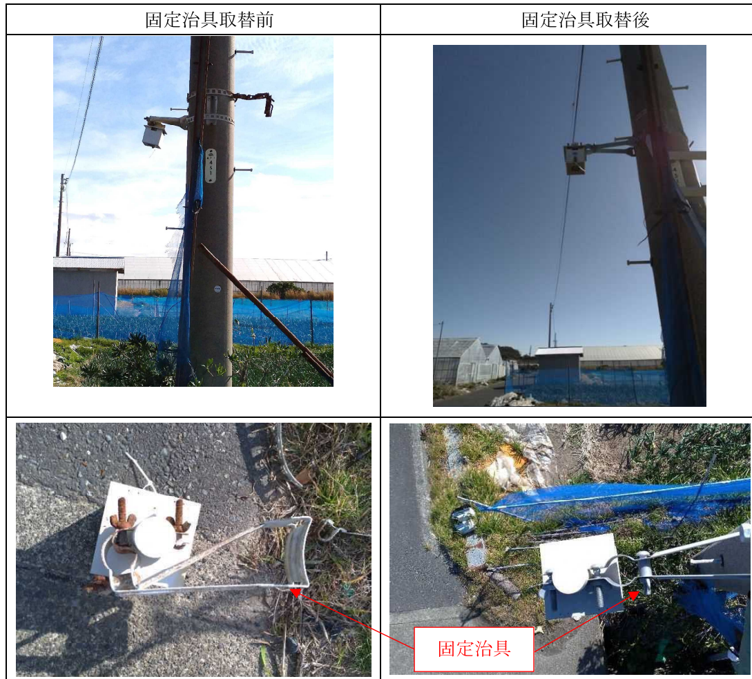
図3 中西のモニタリングポイントの蛍光ガラス線量計固定治具の取替前後の写真
