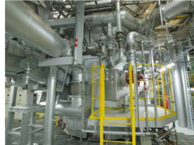
■燃焼室 溶融炉より発生した熱分解ガスを完全燃焼する独立した燃焼室です。 Combustion chamber The thermal decomposition gas from the melting furnace is completely combusted in this independent combustion chamber.
