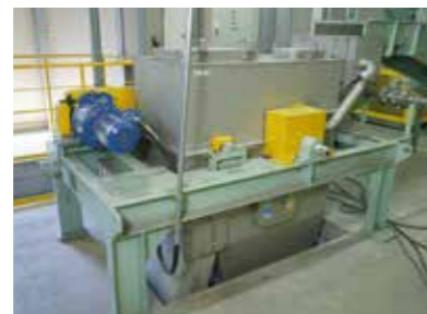
■水砕ピット 溶融炉下部より出湯した溶融物を急速冷却します。 Quenching tank Melt tapped from the base of the furnace is quenched here.
