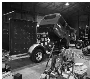
機装途中の消防ポンプ自動車(同型)
