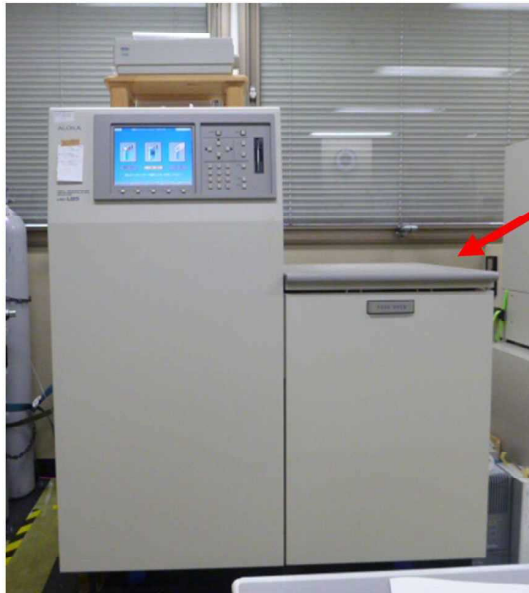
液体シンチレーションカウンタ
