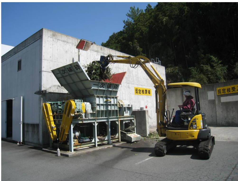
たい肥化施設における剪定枝の資源化（破碎機への搬入）
