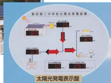
太陽光発電設備
