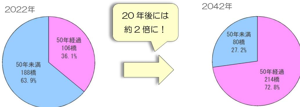
図 1.1.2 架設後50年を経過する老朽化橋梁の割合
