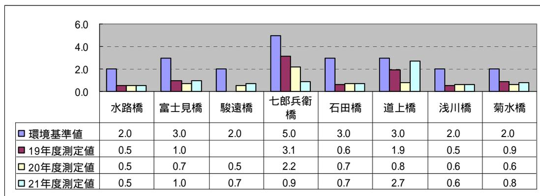
BOD：微生物によって水中の有機物が酸化分解される際に消費される酸素の量をmg/ で表したもので、その数値が大きければ、その水中には汚濁物質(有機物)が多く、水質の汚濁が高いことを意味する。
