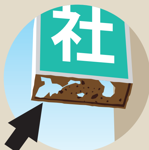
側板底面の腐食、破損
