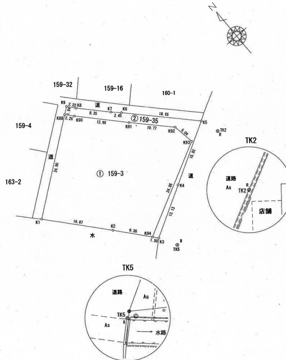
筆界標号 S…石杭、C…コンクリート杭、P…プラスチック杭、R…金属釘、M…刻ミ、RM…金属標 (単位m)
