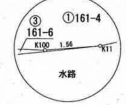
筆界標路号 S…石杭、C…コンクリート杭、P…プラスチック杭、R…金属釘、M…刻ミ、RM…金属標 (単位m)
