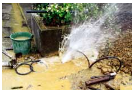
老朽化で破裂した給水管
