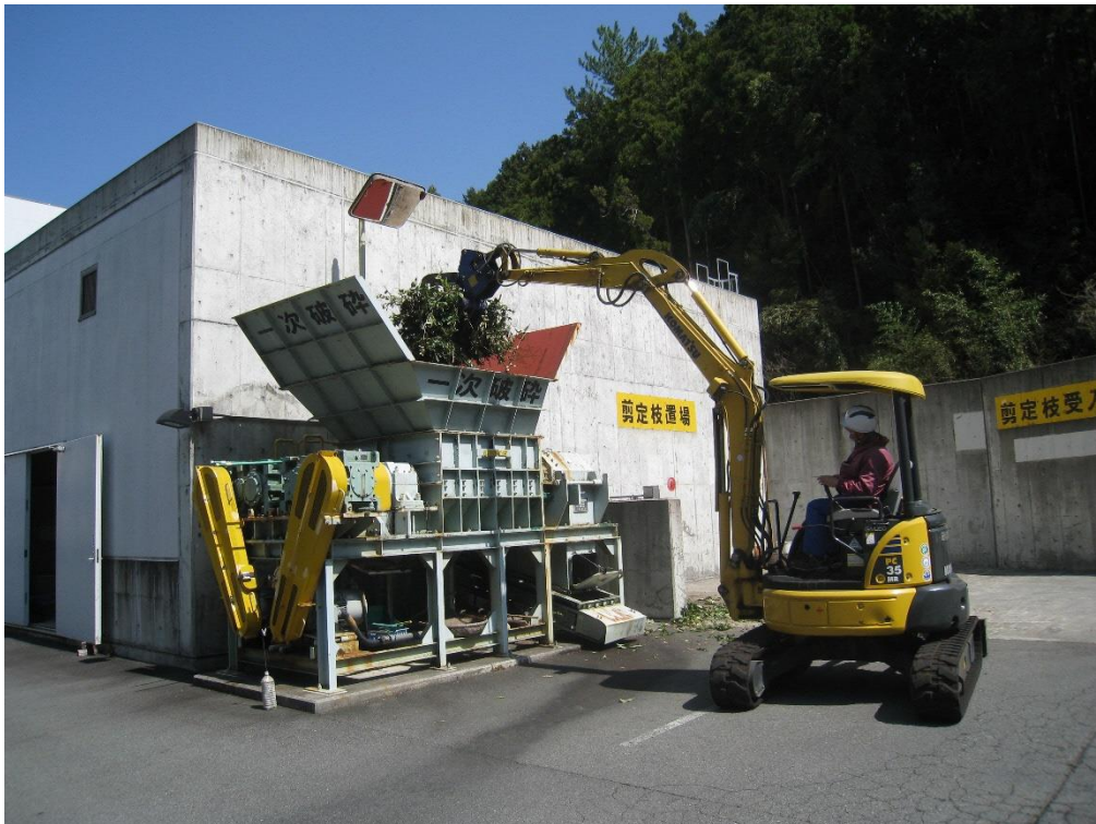
たい肥化施設における剪定枝の資源化（破砕機への搬入）
